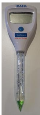
Figure 05 : électrode digitale portative calibrée pour mesurer le pH, modèle HI981034.
