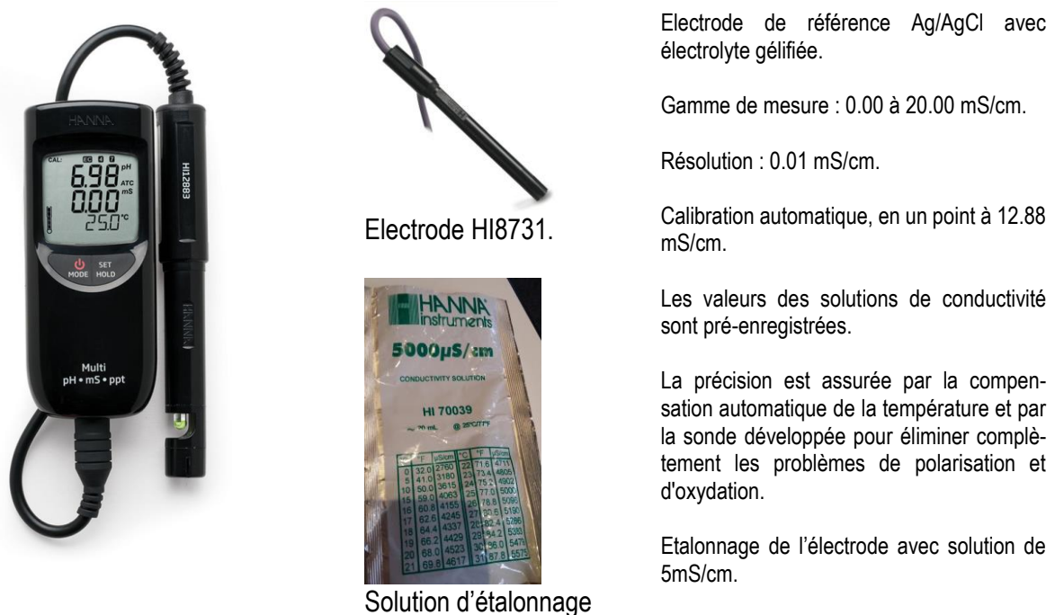
Figure 06 : électrode digitale pour la mesure de la conductivité électrique, modèle HI91301.
