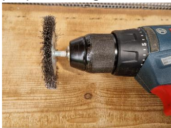
Rendre les parois intérieures des ruches rugueuses à l'aide d'une perceuse et d'une brosse métallique : plus c'est rugueux, mieux c'est !
